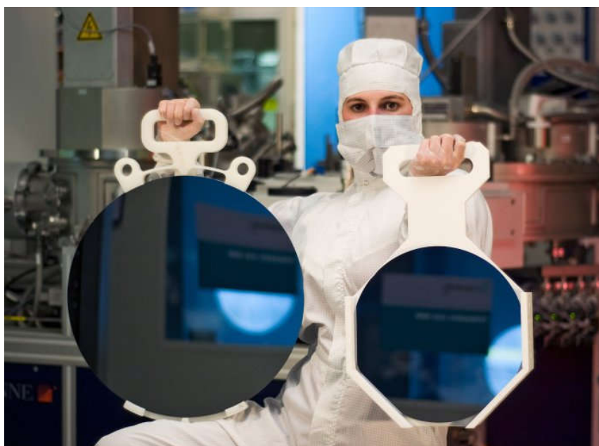
Рис. 6 Внешний вид полупроводниковых подложек. Сравнение 450 мм и 300 мм подложек
